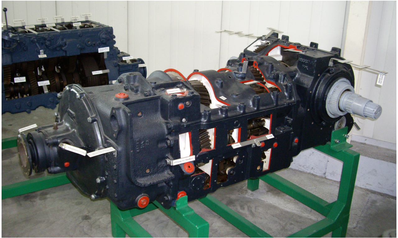
Panther gearbox – Wehrtechnische Studiensammlung Koblenz (Germany)
