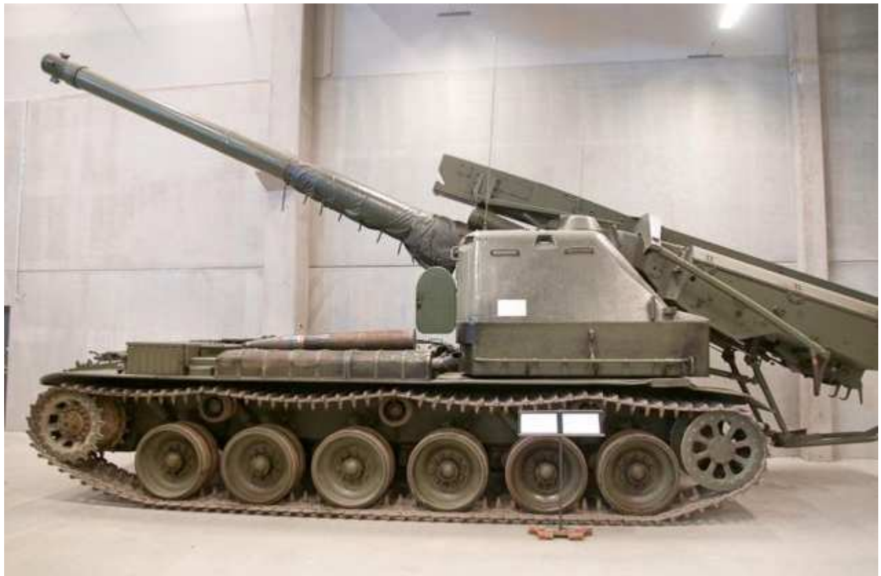
Artillerikanonvagn Akv 151 (12) – Arsenalen Tank Museum, Strängnäs (Sweden) It is the prototype of Bandkanon Bkan 1
